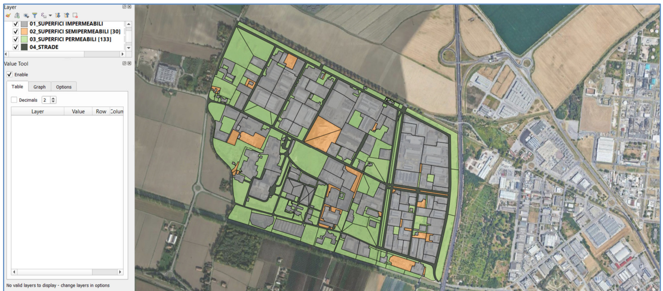
Fig. 82 – Suddivisione delle aree scolanti in impermeabili-semiimpermeabili-permeabili
