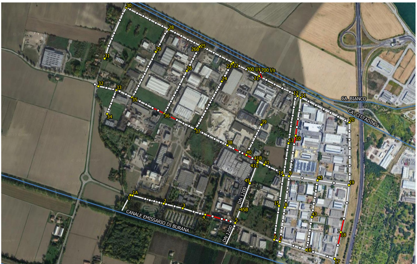
Fig. 89 – Estratto GIS con indicazione dei tratti di rete fognaria per i quali è prevista la sostituzione / miglioramento
